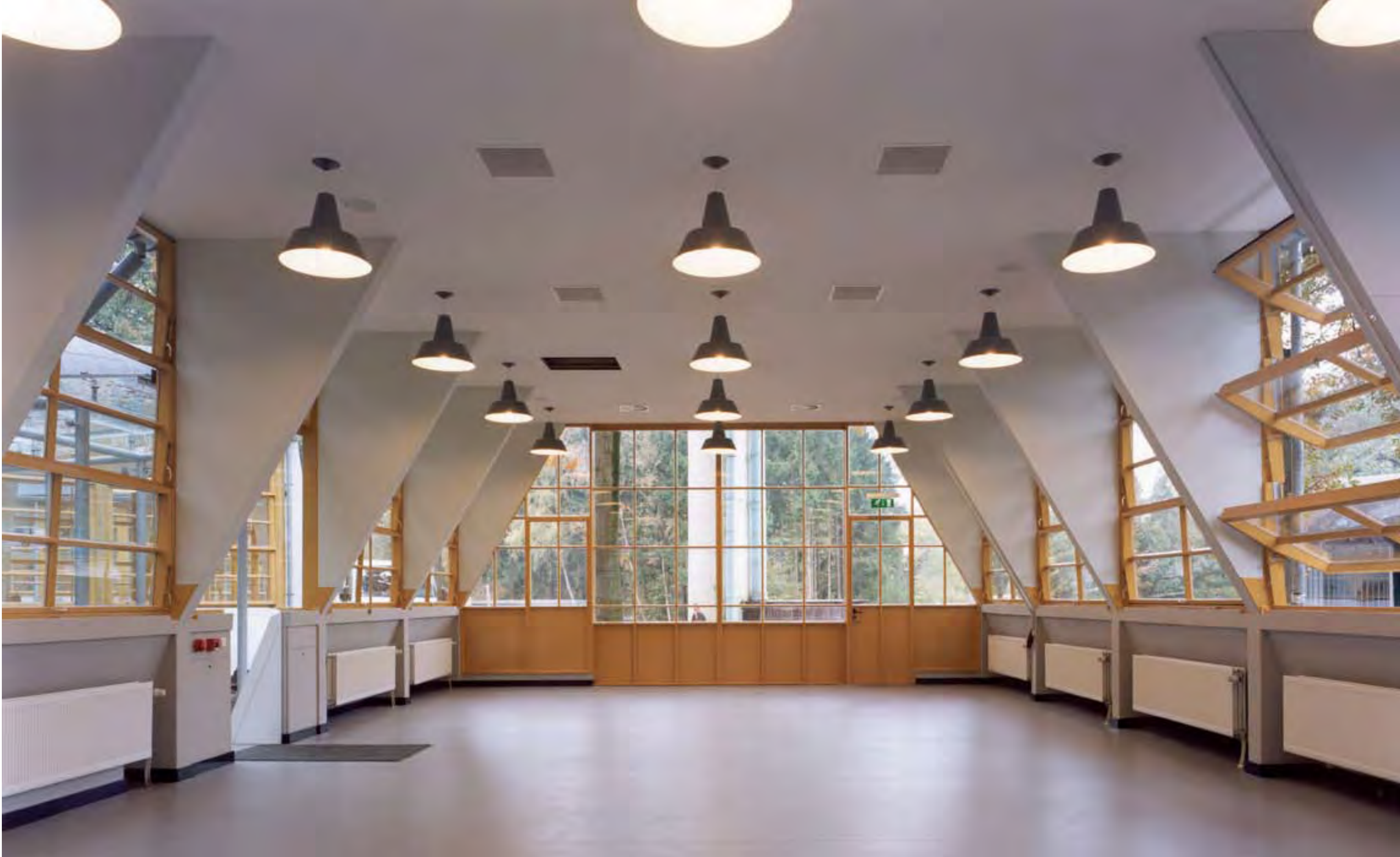
44 De middelste werkplaats na de restauratie. Net als bij het hoofdgebouw zijn de verlichtingsarmaturen nageemaakt en voorzien van PL lampen in een warme lichtkleur.
